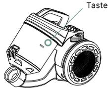
03. Um den Staubbehälter zu entfernen, drücken Sie die Pfeiltaste.
