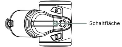
04. Drücken Sie auf das Schloss des Behälters, um ihn zu öffnen. Schütten Sie den Staub aus dem Behälter.
